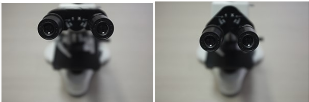
Рис. 3. Положение окуляров на бинокулярной насадке
