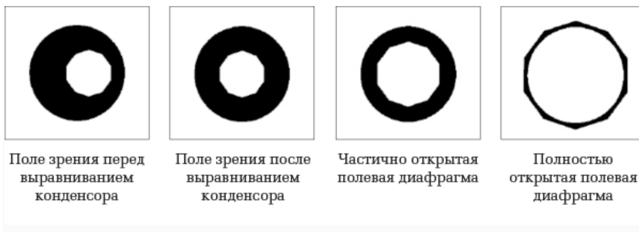
Рис. 9. Варианты полей зрения при разном положении диафрагмы
