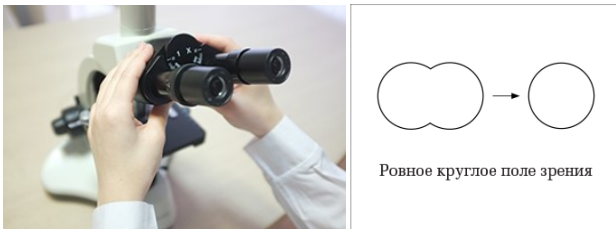
Рис. 6. Регулировка бинокулярной насадки в соответствии с полями зрения
