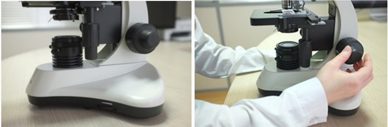
Рис. 4. Работа с макровинтом микроскопа
